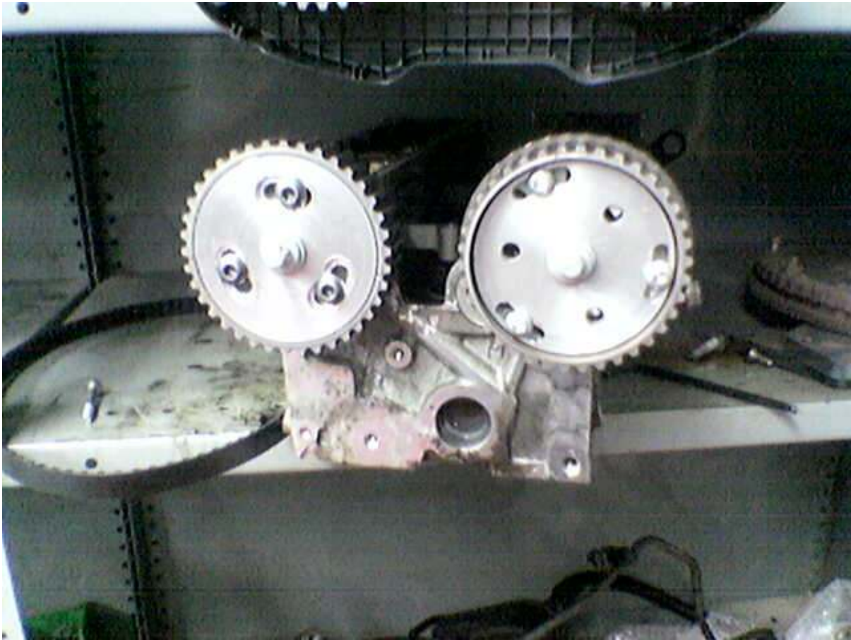
KUVA4. Harjoitustyönä valmistin säädettävät nokkapyörät kilpa-autoon.
