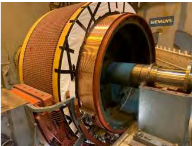
Valssituolin F4-päämoottorin roottori, jonka kommutaattori on sorvattu
