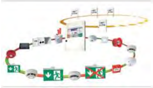
Paloturvalaajärjestelmän rakenne (ST-käsikirja 10, 2020, 66)
